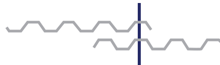
Posición doble (mejor impermeabilización)
