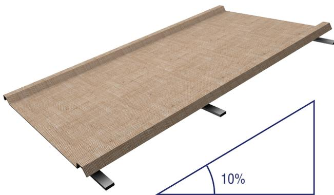
La lámina se debe de fijar con un tornillo de mínimo 2 pulgadas en las crestas (la costilla de la lámina que es en los traslapes laterales) y de 1 pulgada en los valles ( la parte plana).
